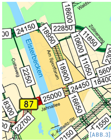
[ABB. 3] Kartenausschnitt Kfz/24h (DTV), Leipzig / Extrait de carte nombre de véhicules motorisés/24h (TJM) / Dettaglio mappa veicoli a motore/24h (TGM) (Quelle: Stadt Leipzig)
